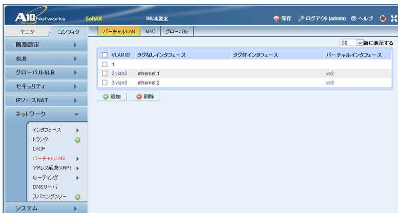
先に定義した VLAN インターフェースに IP アドレスを設定します。”ネットワーク” >> “インターフェース” >> “バーチャル”でリストを表示し、IP アドレスを設定する VLAN の”インターフェース”をクリックし、設定画面を開きます。
